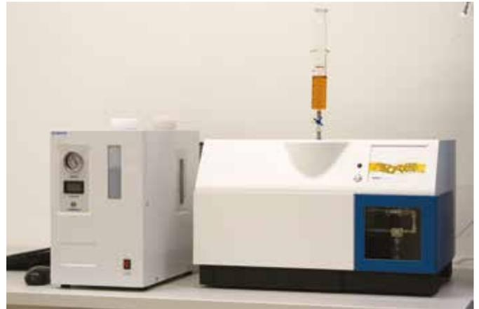
Lorsqu'un défaut thermique ou électrique se développe, le fluide diélectrique et l'isolation solide se décomposent partiellement en gaz de faible poids moléculaire. L'analyse de la quantité et des rapports de ces gaz de défaut permet d'identifier les processus de défaut tels que l'effet corona, l'étincelle, le vieillissement excessif, la surchauffe et l'arc électrique. L'analyse des gaz dissous est réalisée dans le laboratoire interne de NovAcec conformément aux normes CEI 60567 et ASTM D3612.
